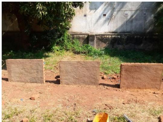
Figura 2: Preparação das paredes para a realização da simulação de penetração de água da chuva
