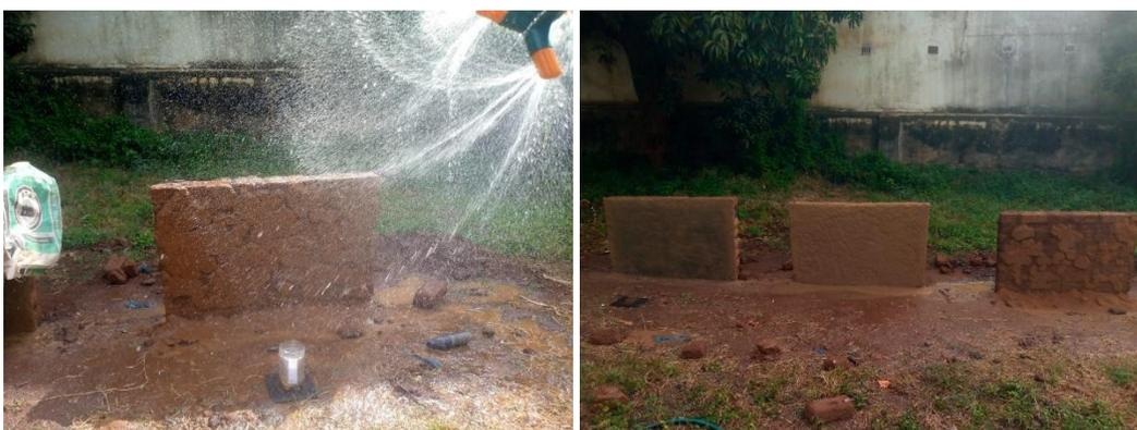
Figura 3: Simulação á penetração de água da chuva nas paredes
