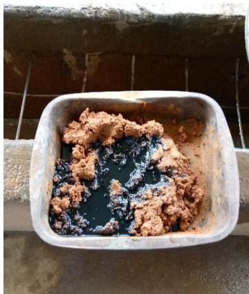
Figura 1: Preparação das argamassas mistura do solo com o óleo queimado de motor
